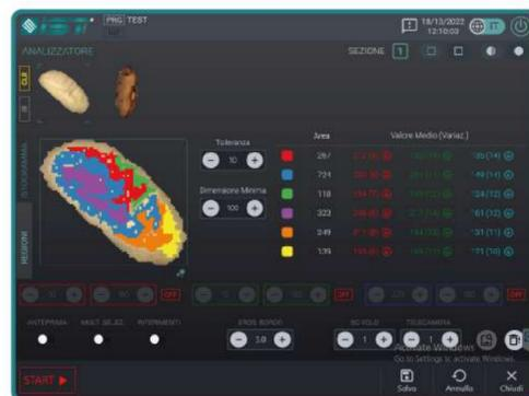
Software **sviluppato internamente**, con l'obiettivo di permettere all'operatore la totale gestione dei programmi in completa autonomia. Grazie ad un sistema di **Auto-apprendimento**, sarà possibile creare un programma in pochi minuti attraverso l'acquisizione automatica delle immagini dei prodotti conformi e di tutti i difetti da scartare.
